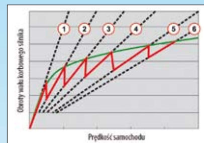
Podział zakresu pracy przekładni Lineartronic na 6 przełożeń.
